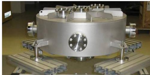
Figure 4.3.12 : New coupling cavity
